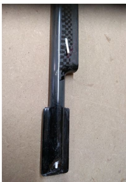
Detail vyvedení bowdenu SOP/VOP
